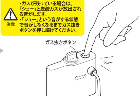
\*空の状態は、ガス抜きボタンを押しても、炭酸ガスが放出される音がしません。音がした場合は音がなくなるまで、ガス抜きボタンを押し続けてください。
