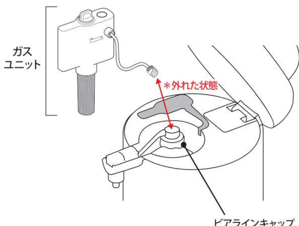
**厳守** ②ガス抜きボタンをゆっくり押し、炭酸ガスが完全に空の状態\*になっていることを確認する
