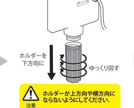
\*炭酸ガスが空になっていない状態で、素早くホルダーを取り外すと急に炭酸ガスや粒状のドライアイスが噴出することや稀に炭酸ガスカートリッジやホルダー部分が勢いよく飛び出すことがあります。
