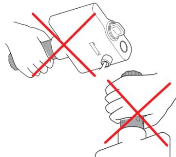
**禁止** ガスユニットがピアラインキャップと接続された状態のまま炭酸ガスカートリッジを交換しない
