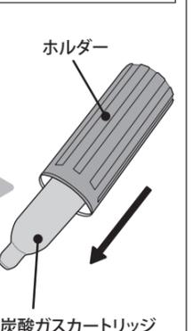
**禁止** ガスユニットとピアラインキャップが接続されたまま、絶対に炭酸ガスカートリッジを交換しないでください。
